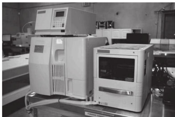
Imagen de equipamiento de ensayo de aceite. El operador debe tomar una muestra de aceite del transformador y realizar un análisis de los gases disueltos.
