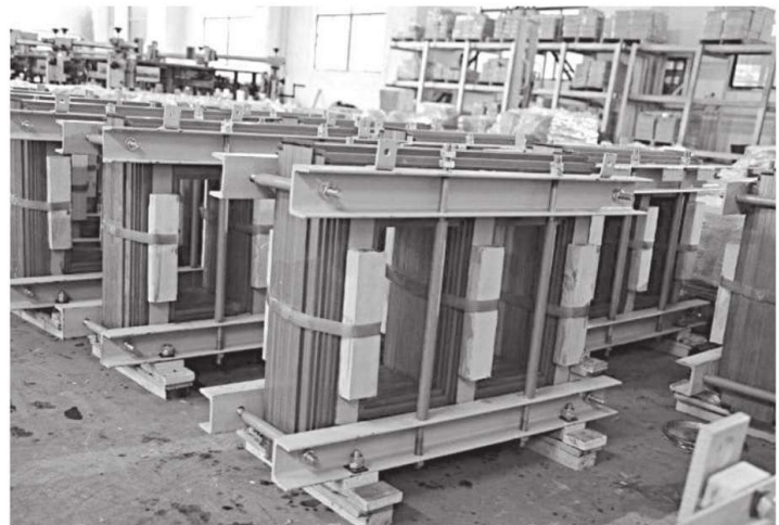
El núcleo armado lleva distintas piezas aislantes, de manera de formar un componente aislado con respecto a las piezas metálicas para fijación y prensado, y con canales para que el aceite aislante lo pueda refrigerar.
