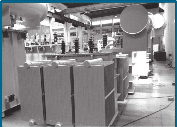
Transformador de distribución trifásico con tanque de expansión y batería de radiadores.
