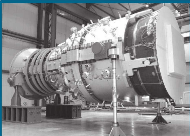
Turbina Siemens SGT5-8000H de 375 MW.
