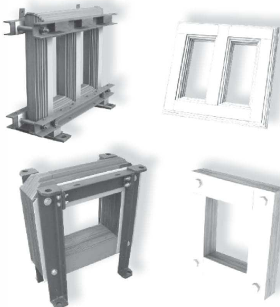
Ejemplos de núcleos con chapas apiladas de dos columnas (para transformadores monofásicos) y de tres columnas (para transformadores trifásicos).
