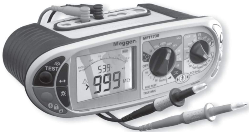
Megóhmetro electrónico digital profesional. Estos equipos son pesados y de dimensiones grandes, pero muy bien aislados para su trabajo.
